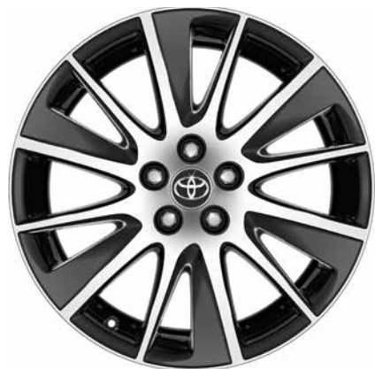
19-дюймовые легкосплавные колёсные диски (6 сдвоенных спиц)
